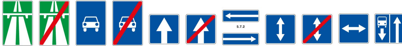
5.1 АВТОМАГИСТРАЛЬ 5.2 КОНЕЦ АВТОМАГИСТРАЛИ 5.3 ДОРОГА ДЛЯ АВТОМОБИЛЕЙ 5.4 КОНЕЦ ДОРОГИ ДЛЯ АВТОМОБИЛЕЙ 5.5 ДОРОГА С ОДНОСТОРОННИМ ДВИЖЕНИЕМ 5.6 КОНЕЦ ДОРОГИ С ОДНОСТОРОННИМ ДВИЖЕНИЕМ 5.7.1 ВЫЕЗД НА ДОРОГУ С ОДНОСТОРОННИМ ДВИЖЕНИЕМ 5.8 РЕВЕРСИВНОЕ ДВИЖЕНИЕ 5.9 КОНЕЦ РЕВЕРСИВНОГО ДВИЖЕНИЯ 5.10 ВЫЕЗД НА ДОРОГУ С РЕВЕРСИВНЫМ ДВИЖЕНИЕМ 5.11.1 ДОРОГА С ПОЛОСой ДЛЯ МАРШРУТНЫХ ТРАНСПОРТНЫХ СРЕДСТВ
