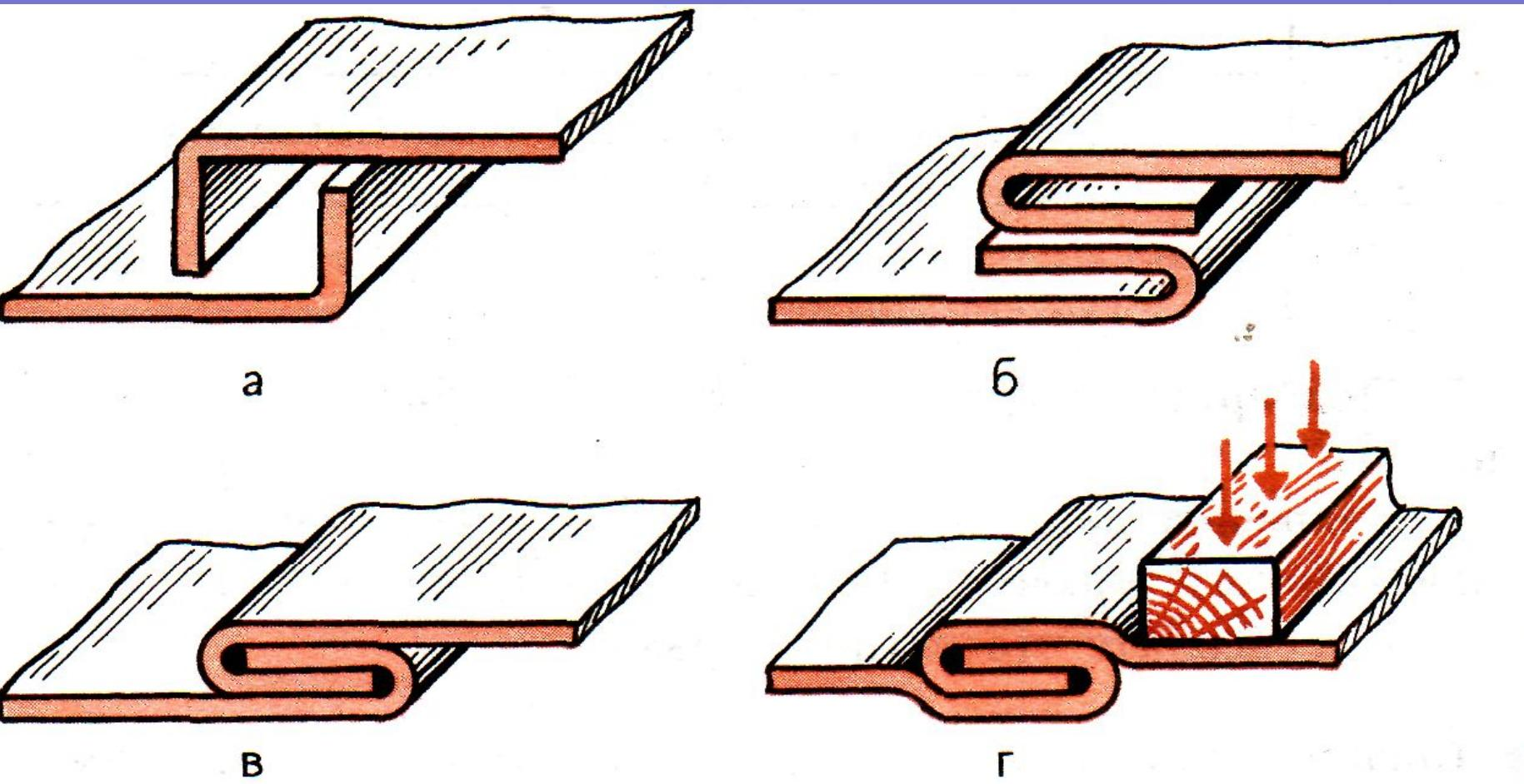
Рис. 88. Последовательность получения фальцевого соединения
