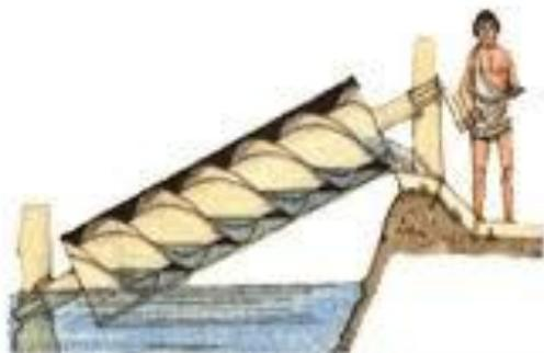
**Винт** — простой механизм. Резьба винта, в сущности, представляет собой другой простейший механизм — наклонную плоскость, многократно обёрнутую вокруг цилиндра.
